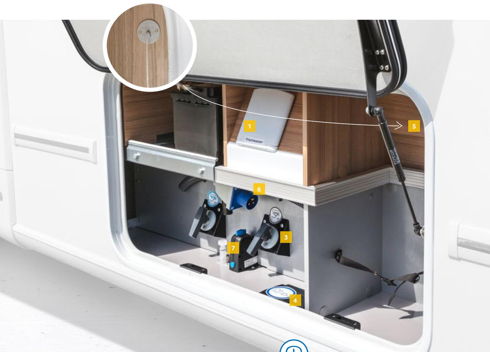
*L'accesso alle aperture per la pulizia del serbatoio dell'acqua è raggiungibile comodamente tramite vani nel doppio pavimento*
